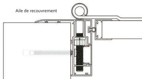
L'**aile de recouvrement** permet de compenser les faux aplombs de la maçonnerie et de masquer la plupart du temps les anciens gonds tronçonnés.
