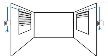
Adapté pour un seul volet roulant à motoriser, le moteur est relié au point de commande par un câblage électrique.
