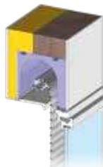
Le coffre tunnel Act'O 1/2 linteau d'Atlantem réunit tous les avantages d'un coffre tunnel (il ne se voit pas) et permet de poser la menuiserie avec son volet en une seule fois.
