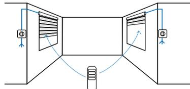
C'est un moteur qui se pilote d'un point de commande mural filaire et par une commande mobile ou par un smartphone.
